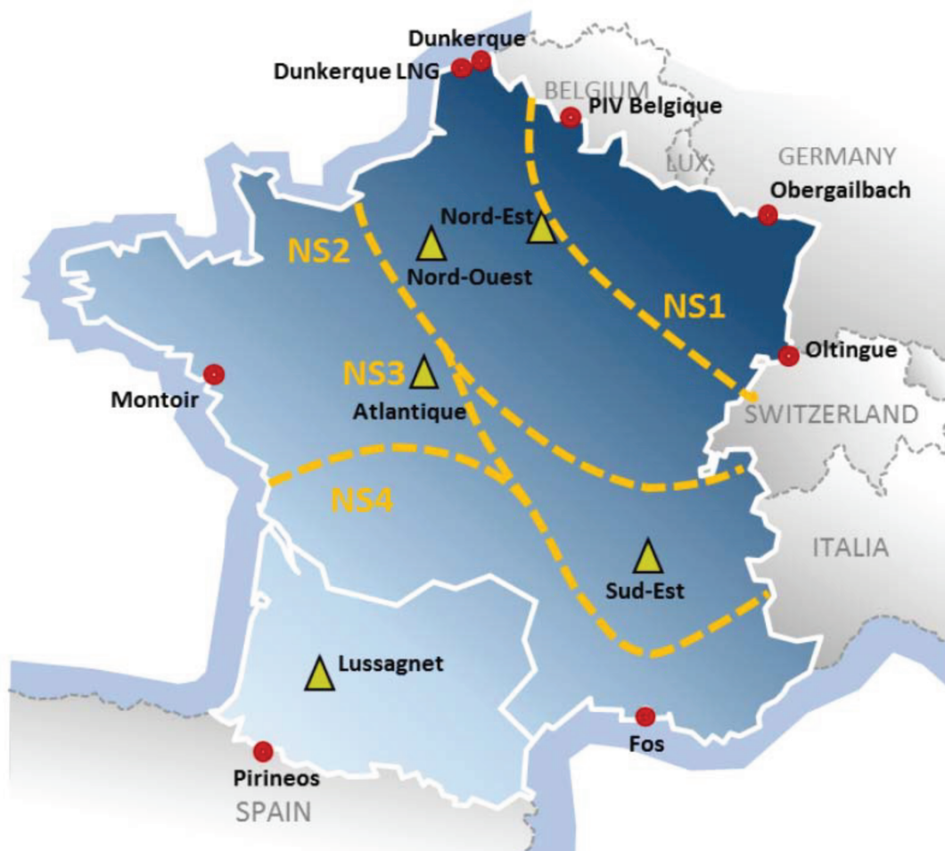
Grappe 9: Principales limites opérationnelles susceptibles d'être observées sur le réseau de transport lorsque les fournisseurs cherchent à maximiser les injections de gaz naturel depuis le nord-est de la France (20)
